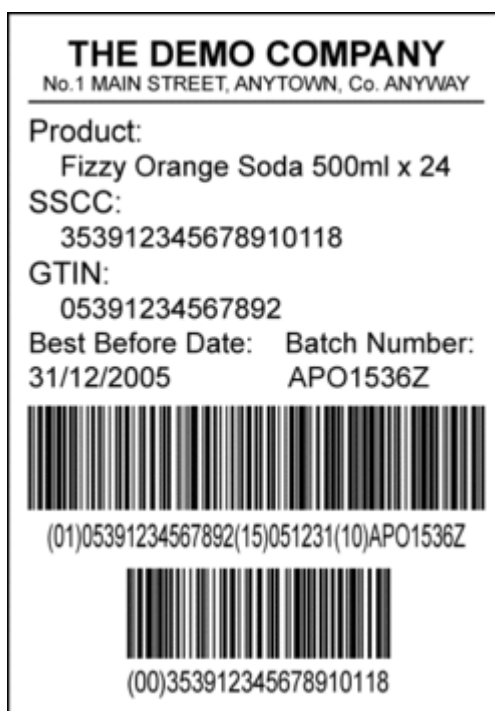
Figura 5.8: Exemplo de etiqueta de utilização baseada na sistemática GS1-128.
